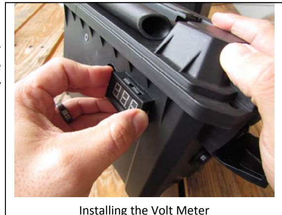
Installing the Volt Meter
